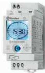
Tipo 12.51.8.230.0000 1 contatto in scambio 16 A 110...230 V AC/DC
