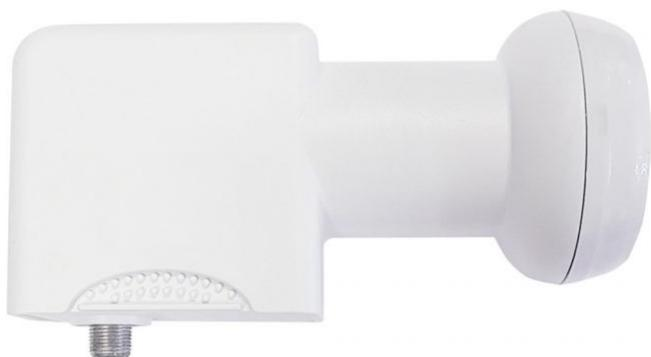
**LNB** con un'uscita **SCD2 (dCSS)** in grado di servire fino a 4 decoder SAT SCR e contemporaneamente offre le 12 frequenze necessarie al funzionamento del nuovo decoder SCD2 (dCSS) **SKY-Q**; il tutto attraverso un solo cavo utilizzando un semplice partitore, ampliando i canali presenti nella distribuzione TV.
