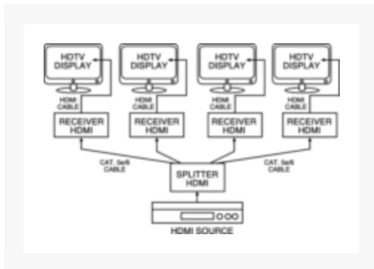
Questo splitter HDMI con estensore di segnale su singolo cavo LAN è un dispositivo ideale per splittare il segnale audio video e permette di estenderlo sino a 50mt mantenendo la qualità HD 1080p 3D.
