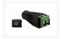
Composto da una spina coassiale diam. Int. 2,1/2,5mm e diam. Est. 5,5mm e un morsetto 2 poli a vite montato sul retro con polarità + e -.
