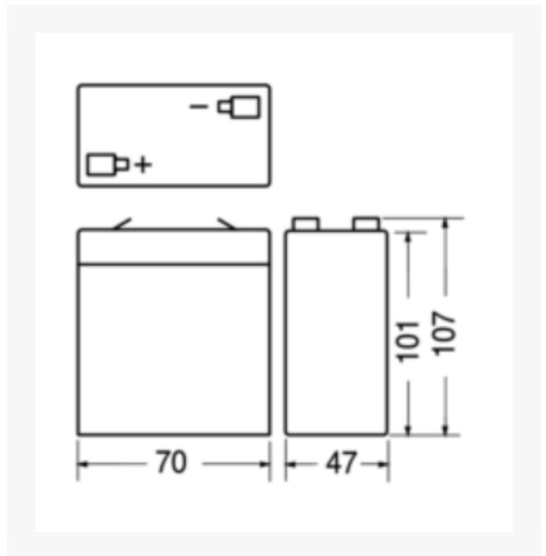
Batteria ermetica senza manutenzione, utilizzabile sia in uso a tampone che ciclico (apparati portatili). Può essere installata in ogni ambiente normale ed all'interno delle apparecchiature elettroniche. Utilizzare sempre un sistema di ricarica appropriato.
