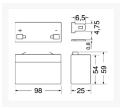
Batteria ermetica senza manutenzione, utilizzabile sia in uso a tampone che ciclico (apparati portatili). Può essere installata in ogni ambiente normale ed all'interno delle apparecchiature elettroniche. Utilizzare sempre un sistema di ricarica appropriato.
