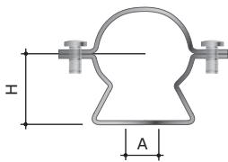
Prodotti da nastro di acciaio inox e successivamente zincati elettrolitici o in acciaio inox AISI 304.
