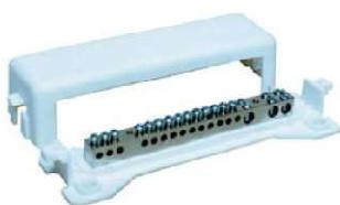
per collegamenti equipotenziali; con coperchio e base in plastica piombabile, ingombro 52 x 185 x 43 mm, barra in ottone nichelato sezione 12 x 12 mm e morsetti numerati.
