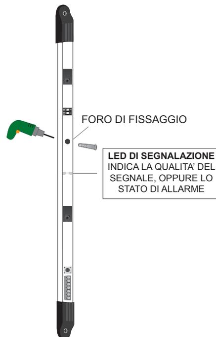
**!** Si consiglia possibilmente di controllare la qualità del segnale nel momento di massima luminosità e anche nel momento di minima luminosità soprattutto se la barriera è esposta direttamente alla luce del sole.
