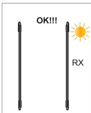
E' molto importante che il ricevitore e il trasmettitore della barriera siano ben allineati per ottenere il miglior risultato in termini di ricezione del segnale. Un errato allineamento può portare ad un malfunzionamento anche dopo un certo periodo di tempo oppure in diverse condizioni di luce.
