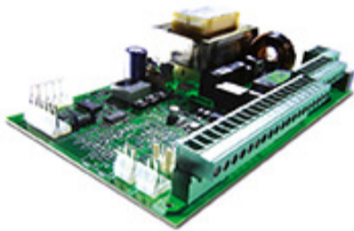
Scheda elettronica 624BLD (incorporata nell'automatismo)
