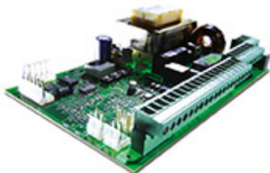
Scheda elettronica 624BLD (incorporata nell'automatismo)
